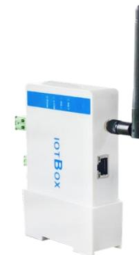
提供 DIN35 导轨卡扣便于安装于各类配电箱中
