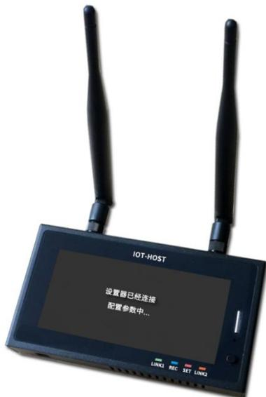
先关机，然后长按银色设置按钮后开机，直到出现处于设置状态界面后方可松开银色按钮，进入设置模式（SET 红灯常亮）后即可进行参数修改，详细网关设置方法参考一下视频演示连接：[https://v.youku.com/v\\_show/id\\_XNDYxOTU5MzQ0MA==.html](https://v.youku.com/v_show/id_XNDYxOTU5MzQ0MA==.html)
