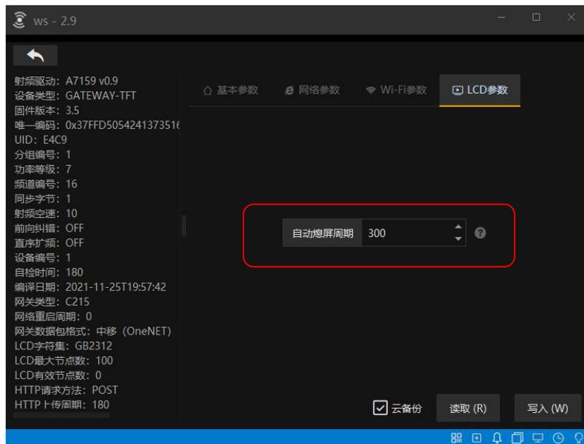
【LCD 参数】WG59-TFT/EG59-TFT/EP59-TFT/WT59-TFT 均集成触摸屏，通过设置 LCD 参数可设置屏幕休眠的时间，即 300 秒后不触控显示屏后将关闭背光，当时间该为 0 时，屏幕将常亮。该功能主要为了降低设备功耗，其次由于内部无风扇等散热功能，休眠屏幕可提高产品的稳定性和使用寿命。当屏幕休眠后，用户只需触控屏幕即可唤醒屏幕。
