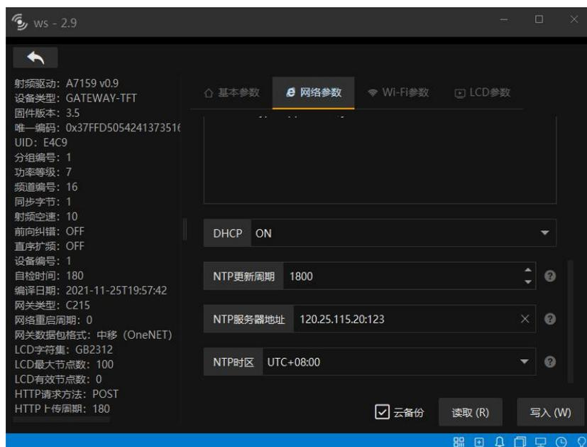
EG59-TFT/EP59-TFT/WT59-TFT 显示的时钟信息会定时自动联网更新，所以设备在国内使用时，【NTP 更新周期】、【NTP 服务器地址】、【NTP 时区】这三个参数默认即可，如果在国外使用时，需要调整【NTP 时区】
